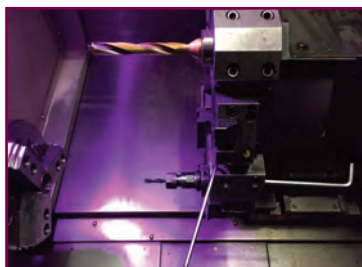
4. 풀었던 GYRO척 뒤쪽 볼트를 잠고 터렛의 홀더 고정볼트 위,아래를 한번에 천천히 잠가준다. Please fasten bolt in turret and bolt in GYRO chuck
